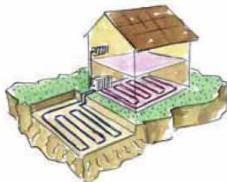
Capteurs horizontaux enterrés à environ un mètre
